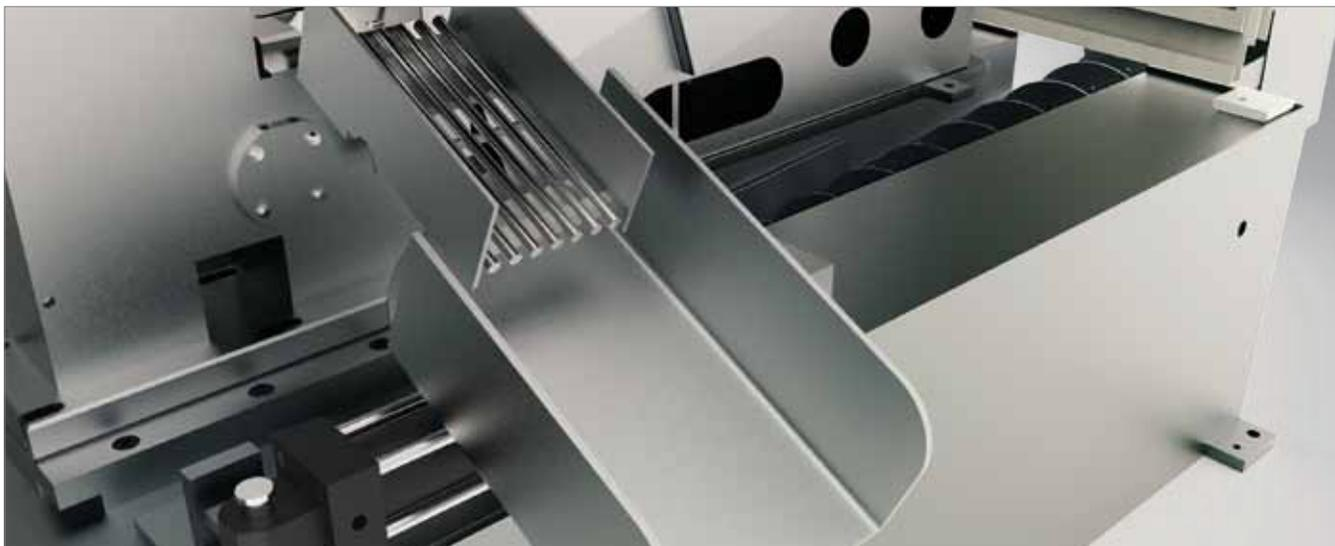
\_Arretramento automatico dell'alimentatore al termine di ogni taglio per evitare lo sfregamento con il materiale.
