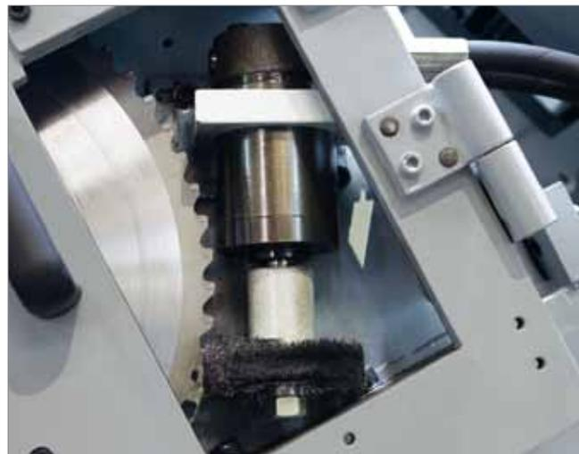
\_Lubrificazione automatica di tutte le parti mobili per garantirne il corretto funzionamento. La lubrificazione può essere temporizzata tramite il controllo della macchina.
