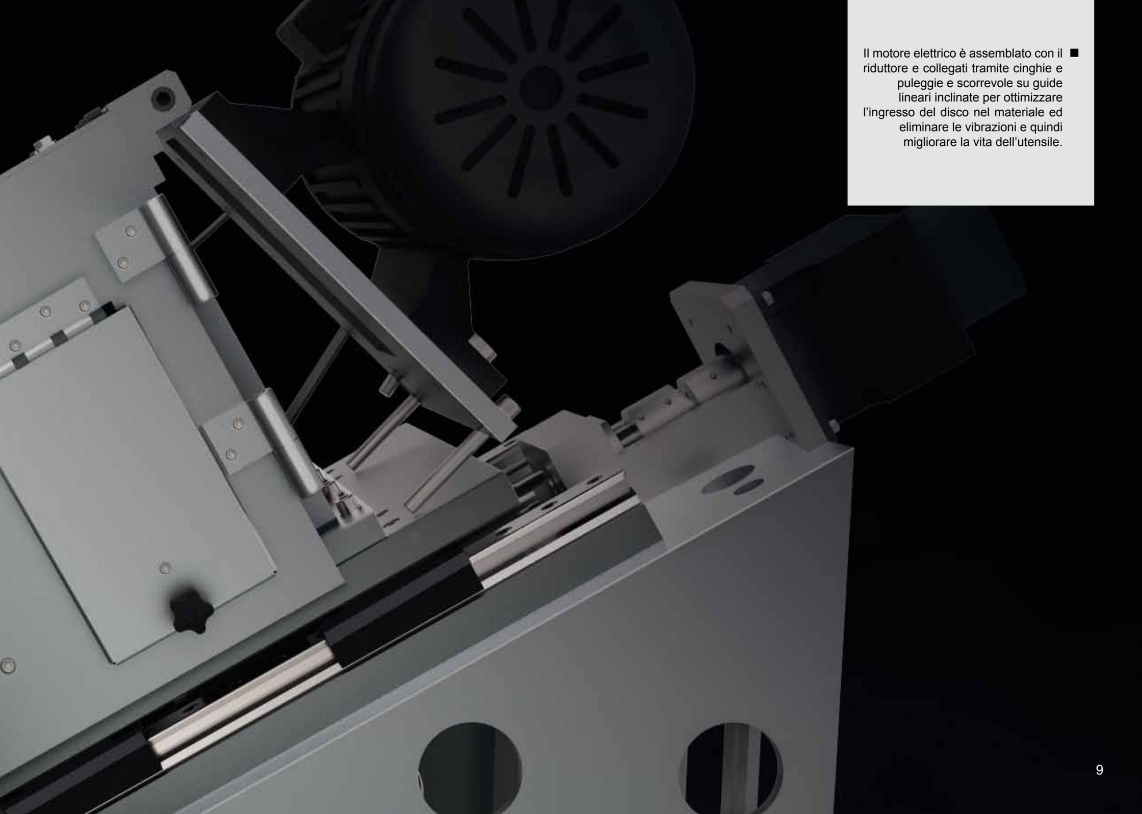
Il motore elettrico è assemblato con il ■
