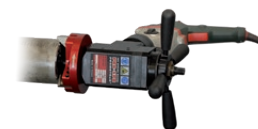
PRO-5 PB • Tubi con diametro interno 32 mm fino a 114 mm di diametro esterno (opzionale: diametro interno 25 - 32 mm) (opzionale: diametro esterno 140 mm) • Smussatura a "J"
