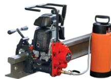
PRO-36RH • Fresa a corona: max 36 mm • Motore a scoppio
