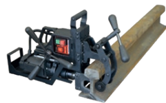
PRO-36R • Fresa a corona: max 36 mm • Motore elettrico
