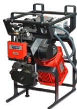
ABM-14 • Smusso di larghezza fino a 14 mm • Angolo di smusso: 22.5°, 25°, 30°, 35°, 37.5°, 45° • Smussatura inferiore e superiore
