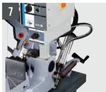
7 SHARK 281 - KIT CCS Cut Control System (dispositivo per taglio senza operatore)
