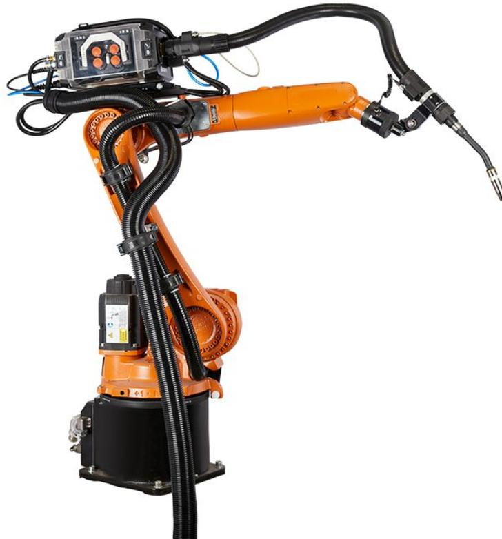
Kemppi offre pacchetti di torce robotizzate sia per robot con polso cavo che senza. Il sistema perfetto di torcia per la saldatura ad arco robotizzata è costituito da una lancia della torcia con un supporto della punta, un ugello del gas e un gruppo cavo. Una torcia robotizzata può essere montata su un adeguato supporto per torcia di Kemppi.
