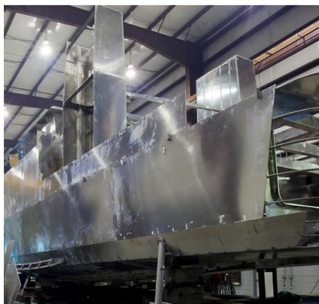
Il processo MIG pulsato minimizza il livello di spruzzi e l'apporto termico, semplifica la saldatura in posizione
